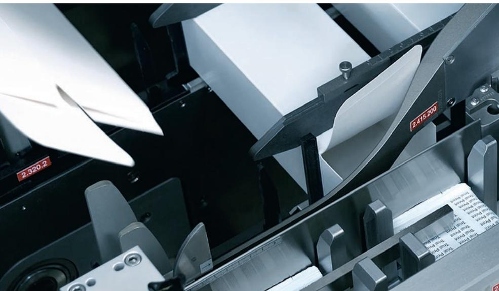
Für die Kartonierung der instabilen Stapel in zwei Schritten entwickelte das Technikteam einen Gegenhalter, der einen sicheren Einschub ermöglicht.
