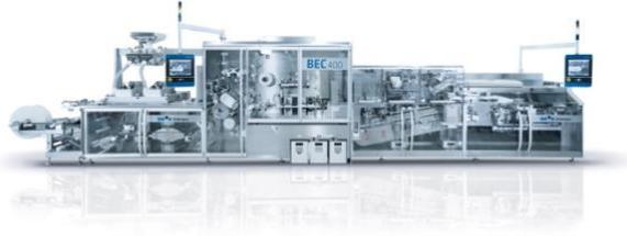
Mit der **Blisterlinie BEC 400** zeigt Uhlmann Pac-Systeme eine Lösung für Solida-Verpackungen an, die auch recyclingstarke Monostoff-PP-Blister verarbeitet und die bereits prozesssicher bei Kunden läuft. Die BEC 400 vernetzt Zuführung, Blistermaschine und Kartonierer auf weniger als neun Meter Länge zu einer hochleistungsfähigen Einheit.
