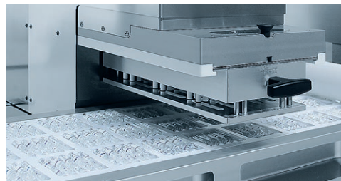
压入工位可最大限度地减少产品损坏。
